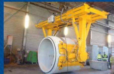
Vakuumheber zum Entschalen und Drehen
