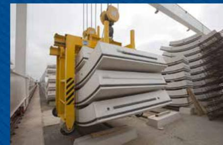
Hydraulische Hebezeuge mit Eigenantrieb
