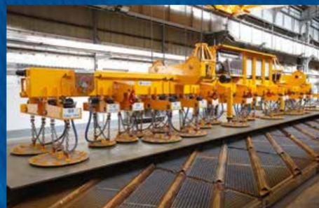
Saugtraverse für Aluminiumplatten
