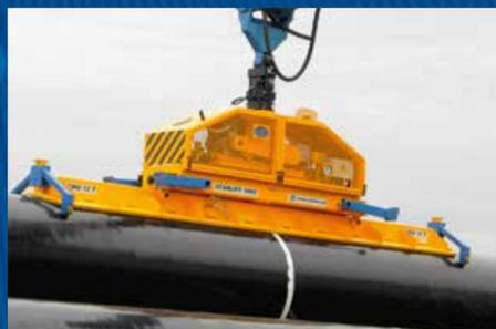
Vakuumsystem für Rohre
